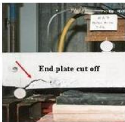
شکل ۳- شکست‌های زودرس متداول تیر بتنی تقویت شده در بار نهایی
