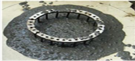
شکل ۳- آزمایش حلقه J بتن خودتراکم در آزمایشگاه
