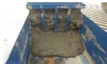
شکل ۱۱- انسداد بتن در آزمایش جعبه L
