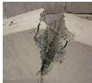
شکل ۱۸- تیر بتنی الیافی با شکست نرم در آزمایش خمش
