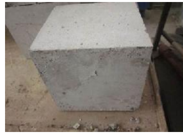
شکل ۱۶- نمونه بتن الیافی مقاومت فشاری بعد از اعمال بار
