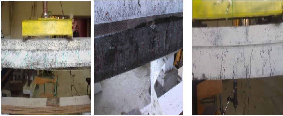
الف- نحوه شکست تیر B_1 ب- نحوه شکست تیر B_2 ج- نحوه شکست تیر B_3 شکل ۸- توزیع ترک‌های تیرهای گروه B
