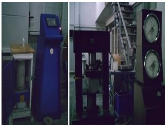
شکل ۵- دستگاه اندازه‌گیری مقاومت کششی و فشاری (آزمایشگاه بتن دانشگاه تبریز)
