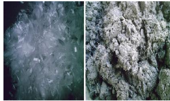
شکل ۳- بتن الیافی و الیاف پلی‌پروپیلنی - نوع staple
