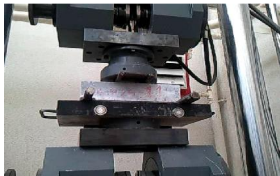
شکل ۹- آزمونه خمشی در حین آزمایش
