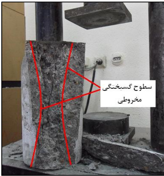
شکل ۱- گسیختگی آزمون استوانه‌ای در فشار
