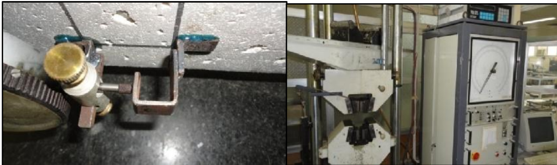
شکل ۶- اتصال کرنش سنج به سطح بتن با پایه‌های فلزی
