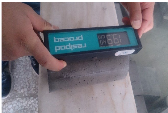
شکل ۱۶- دستگاه اندازه گیری مقاومت ویژه الکتریکی
