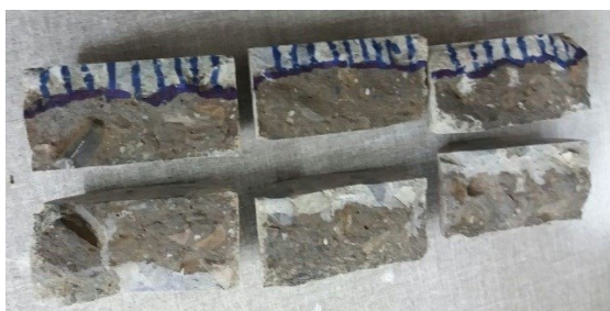
شکل ۲۰- اندازه گیری عمق نفوذ کلر
