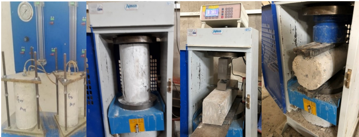
شکل ۳- آزمایشات مقاومت فشاری، مقاومت کششی، مقاومت خمشی و نفوذ آب تحت فشار
