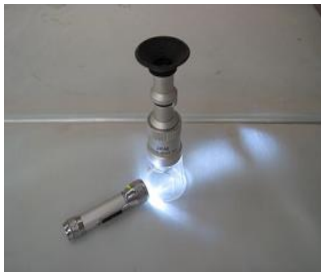
شکل ۳- دستگاه ویژه پایش ترک
