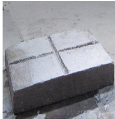
شکل ۱- تصویر بتن پایه با شاخص قید ایجاد شده بر روی بتن پایه
