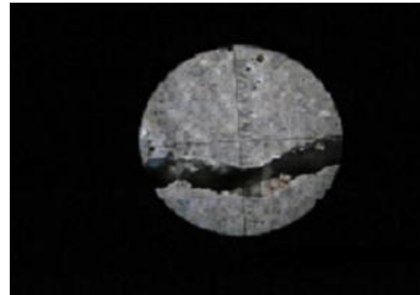
شکل ۴ - تصویر گرفته شده از ترک با دوربین
