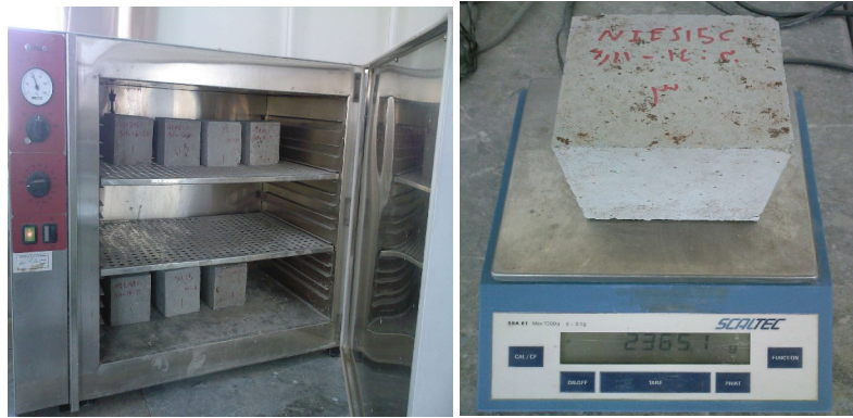
شکل ۴- آزمایش تعیین درصد جذب آب نمونه‌ها
