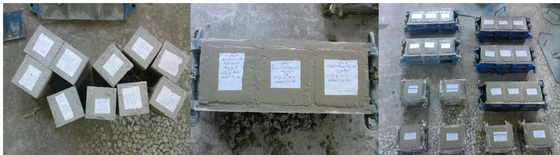
شکل ۲- قالب‌های مورد استفاده و نمونه‌های ساخته شده
