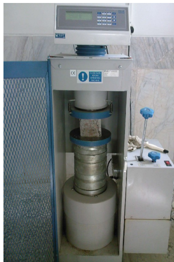
شکل ۳- آزمایش مقاومت فشاری بتن
