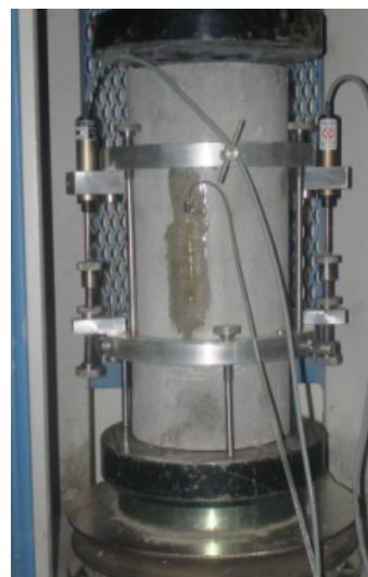
شکل ۲- آزمایش تعیین مدول الاستیسیته
