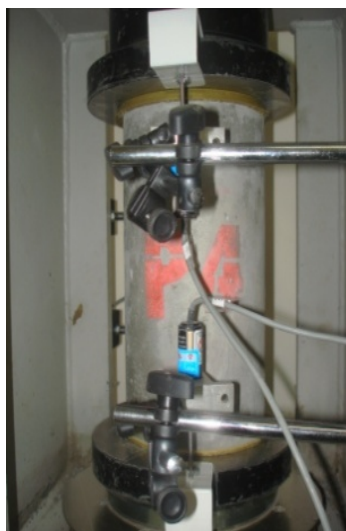
شکل ۳- آزمایش تعیین منحنی تنش - کرنش
