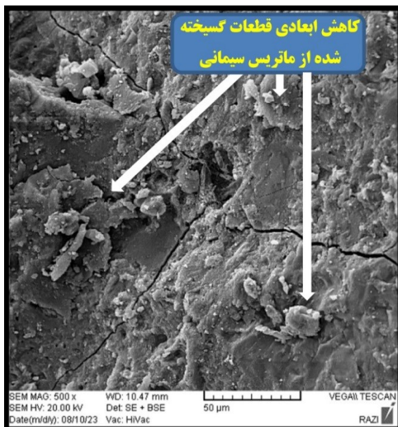
شکل ۲۰- نمونه حاوی اکسید گرافن و روباره (۵۰۰ برابر)
