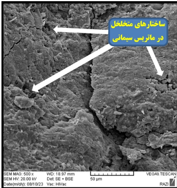
شکل ۱۹- نمونه فاقد اکسید گرافن و روباره (۵۰۰ برابر)
