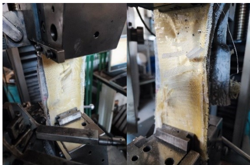
شکل ۵- روند توسعه ترک ونحوه گسیختگی ناشی از کشش مستقیم در بتن پارچه‌ای تقویت‌شده با ۳ لایه AFRP
