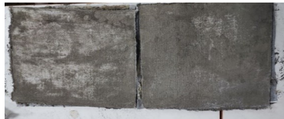
شکل ۲- نمونه پنل‌های بتن پارچه‌ای ساخته شده پیش از اسپری آب و شروع عمل‌آوری
