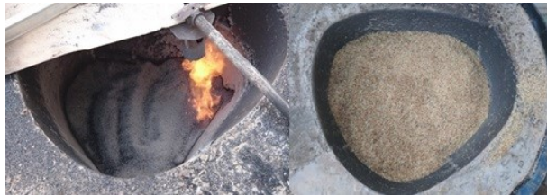
شکل ۳- پوسته برنج و سوزاندن آن در کوره بتنی محیطی
