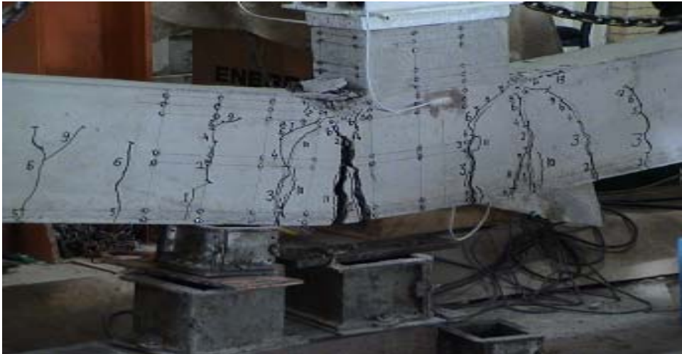
شکل ۲: نمایی از اتصال در هنگام تخریب
