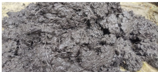
شکل ۲- الیاف فولادی در داخل بتن
