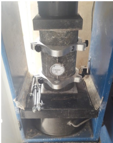
شکل ۲- نمونه تحت آزمایش ضریب ارتجاعی استاتیکی
