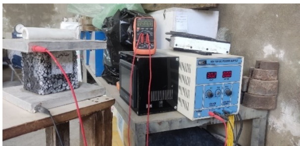
شکل ۴- نمونه بتنی تحت آزمایش مقاومت الکتریکی
