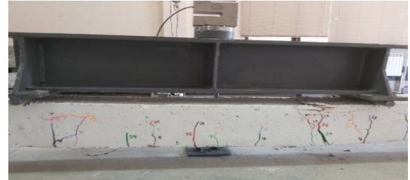
شکل ۱۷ مقایسه بین ترک های ایجاد شده در مدل سازی عددی و آزمایشگاهی تیر بتن مسلح بدون تقویت CB
