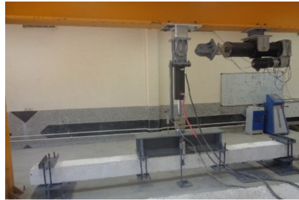
شکل ۳- نحوه ی بارگذاری تیر بتن مسلح در محیط آزمایشگاه
