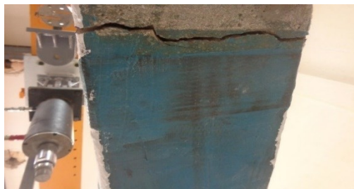
شکل ۱۸-ب- ترک سرتاسری زیر تیر بتن مسلح در قسمت انتهایی ورق CFRP
