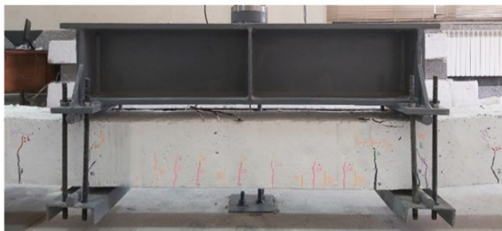
شکل ۱۸- الف مقایسه بین ترک های ایجاد شده در مدل سازی عددی و آزمایشگاهی تیر مقاوم سازی شده RB1
