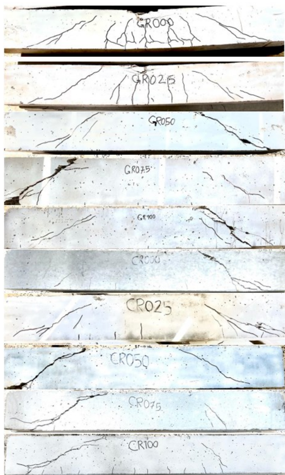
شکل ۱۱- توسعه خطوط گسیختگی برشی در تیرهای ساخته شده با طرح‌های مختلف
