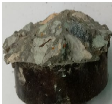
ج) آسیب جزئی ناشی از آزمون
