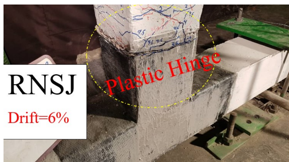
۵- مکانیزم شکست در نمونه کنترلی نمونه بهسازی شده
