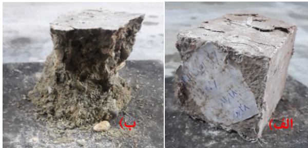
شکل ۷- نحوه شکست بتن پلیمری تحت آزمایش مقاومت فشاری (الف) بتن پلیمری بدون الیاف (ب) بتن حاوی الیاف
