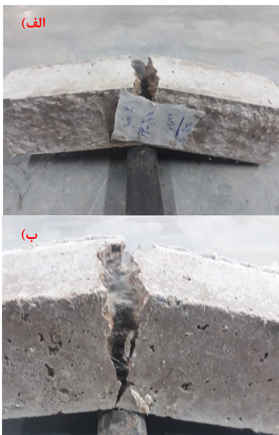
شکل ۱۰- نمونه‌های شکسته شده تحت نیروی خمشی بتن پلیمری (الف) بتن پلیمری حاوی الیاف ۰/۵ درصد پلی‌پروپیلن (ب) بتن پلیمری حاوی الیاف ۲/۵ درصد پلی‌پروپیلن
