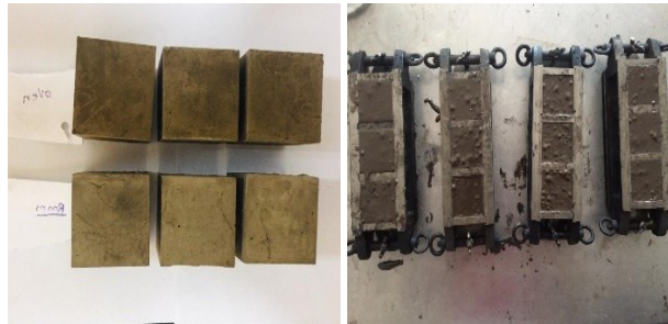
شکل ۲- الف: تصویر سمت راست پر کردن قالب ها با خمیر ساخته شده با خاکستر داسیت. ب: تصویر سمت چپ نمونه های ساخته شده با خاکستر داسیت بعد از ۲۸ روز (ردیف بالا عمل آوری در دمای ۶۰ و ردیف پایین عمل آوری در دمای محیط)
