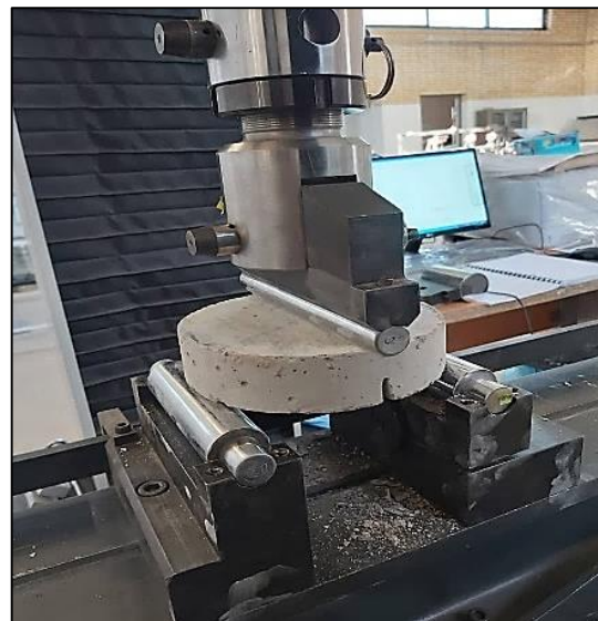
شکل ۷- قرارگیری نمونه های دیسک های خمشی شیاردار تحت بارگذاری مود اول
