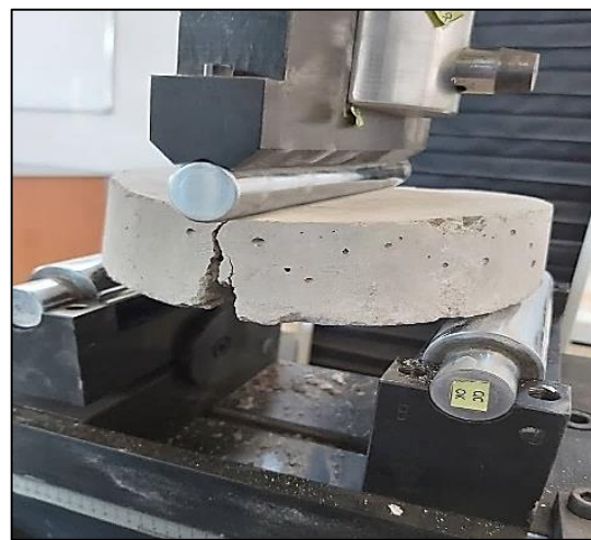
شکل ۱۳- نحوه شکست نمونه دیسک خمشی شیاردار تحت
