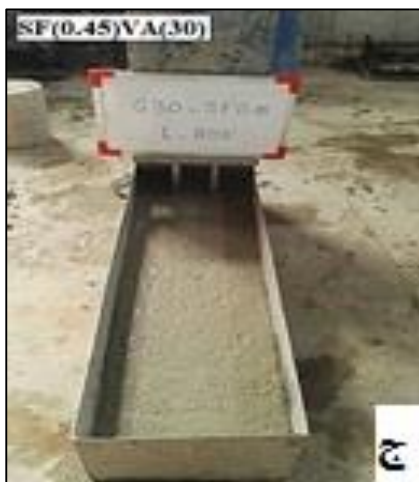
شکل ۴- آزمایشات بتن تازه (الف): جریان اسلامپ، ب: حلقه J و
