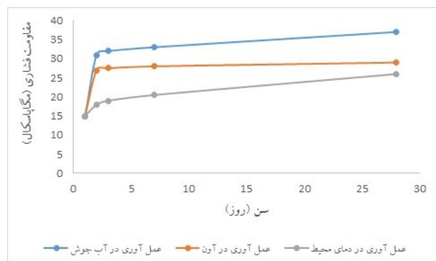
شکل ۷- نمودار مقاومت فشاری-سن بتن ژئوپلیمری بر پایه سرباره کوره آهن گدازی/پودر زئولیت طبیعی حاوی محلول سدیم هیدروکسید با غلظت ۱۲ مول در لیتر
