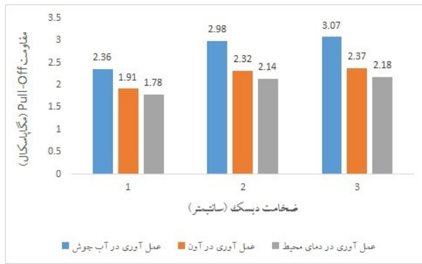
شکل ۱۳- نمودار مقاومت Pull-Off - ضخامت دیسک بتن ژئوپلیمری بر پایه سرباره کوره آهن گدازی/پودر زئولیت طبیعی حاوی محلول سدیم هیدروکسید با غلظت ۸ مول در لیتر عمل آوری شده در شرایط مختلف
