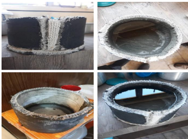
شکل ۸- محصول شکل دهی شده با بتن پارچه‌ای ساخته شده با فناوری ریخته‌گری پلیمری
