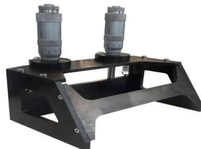
شکل ۲- فیلم کش دکتر بلید جهت پوشش دهی بتن پارچه‌ای
