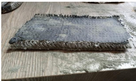
شکل ۴- بتن پارچه‌ای ساخته شده بر پایه روش ریخته گری پلیمری
