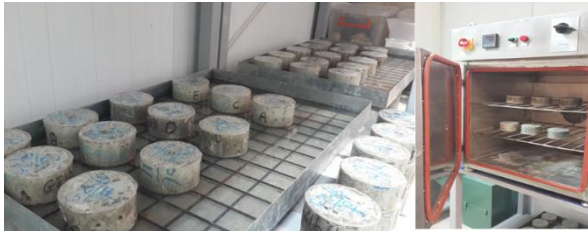
شکل ۱۲- نمونه‌های آزمایشگاهی برای آزمایش جذب آب موئینه بتن
