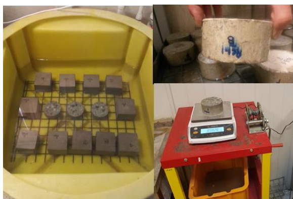
شکل ۱۰- آزمایش جذب آب حجمی بتن
