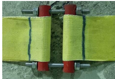
شکل ۲- نحوه اتصال نوارها به ادوات پیش‌تندگی
