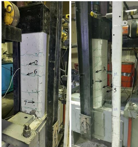
شکل ۶- ترتیب ترک‌های ایجادشده روی نمونه SCR
