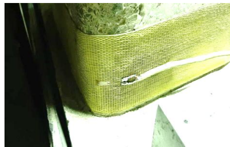
شکل ۳- نصب کرنش‌سنج بر نوار آرامید
