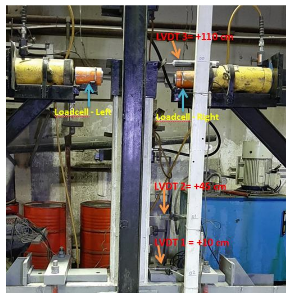
شکل ۴- محل قرارگیری بارسنج‌ها و LVDT ها در زمان آزمایش
