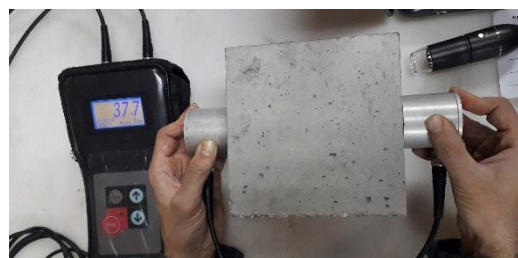
شکل ۵- آزمایش اولتراسونیک بتن
