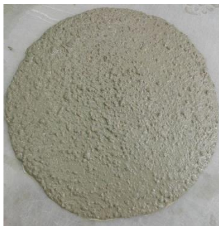
شکل ۲- آزمایش‌های جریان اسلامپ و T50
