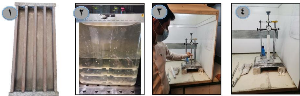
شکل ۸- مراحل آزمایش واکنش پذیری ملات بر اساس استاندارد ASTM C1260
