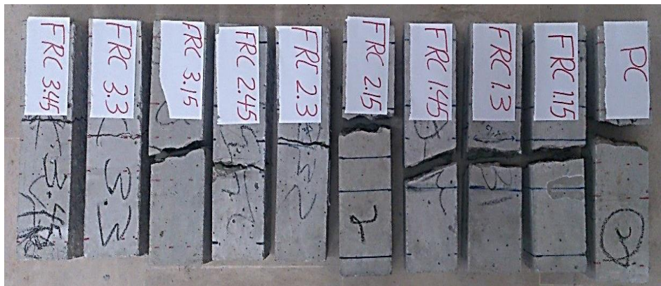
شکل ۷- نمونه های خمشی گسیخته شده
