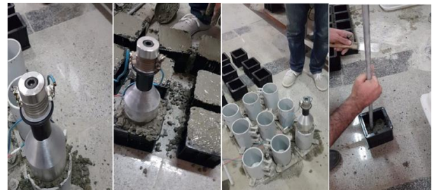
شکل ۵- تصاویری از مراحل ساخت آزمون‌های مکعبی و استوانه‌ای تحت تأثیر امواج
