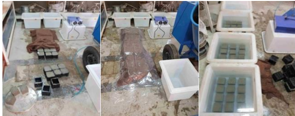
شکل ۶- تصاویری از نحوه ی عمل آوری آزمون‌های بتنی و قرارگیری آنها در حوضچه آب
