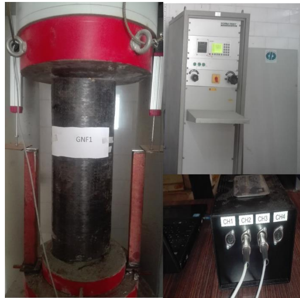
شکل ۶- نحوه آزمایش نمونه ها توسط جک هیدرولیکی ۵۰۰۰ کیلونیوتنی
