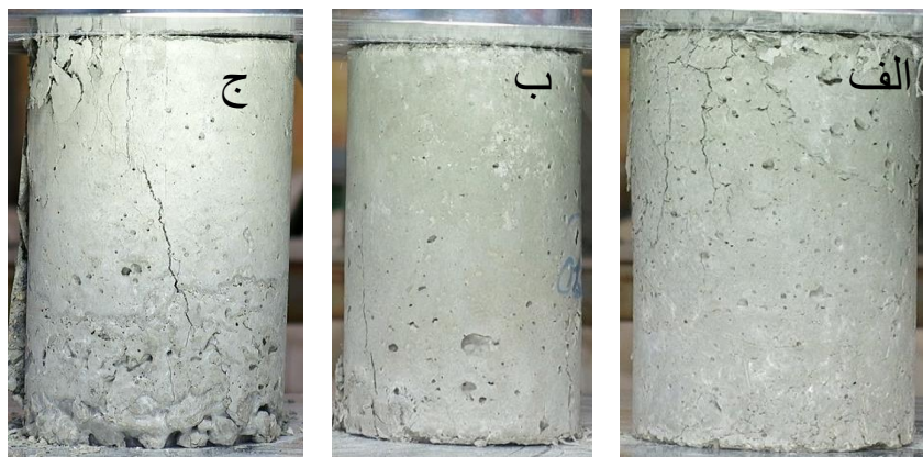
شکل ۶- مقایسه الگوی ترک خوردگی در نمونه‌های استوانه‌ای فشاری تقویت شده با الیاف فورتا: (الف) نمونه F2، (ب) نمونه F1، (ج) نمونه NF
