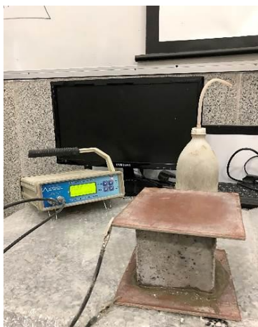
شکل ۷- نمونه مکعبی تحت آزمایش مقاومت الکتریکی
