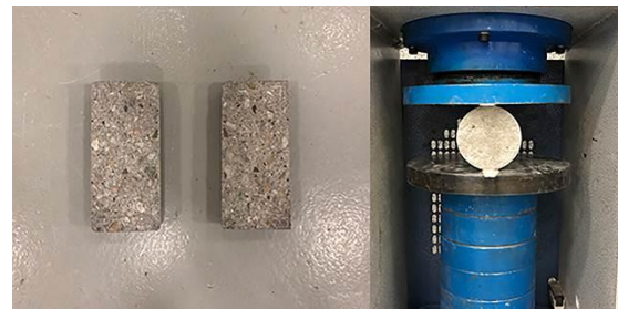
شکل ۵- آزمایش مقاومت کششی دو نیم شدگی (برزیلی)
