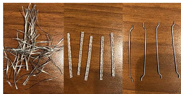
شکل ۳- الیاف فولادی و MEX200 و MEX300
