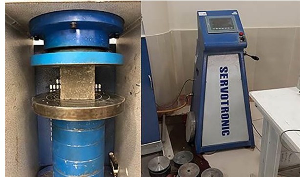
شکل ۴- قرار گیری نمونه زیر جک مقاومت فشاری
