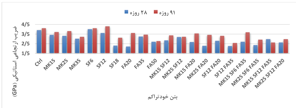
شکل ۶- نتایج آزمایش ضریب ارتجاعی استاتیکی نمونه های استوانه ای استاندارد بتن های خودتراکم تحقیق
