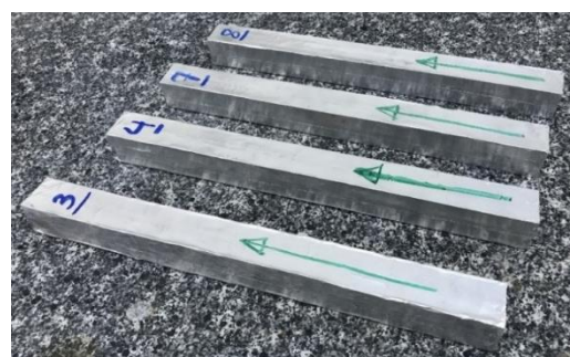
شکل ۱۱- نمونه‌های جمع شدگی ذاتی، پوشانده شده با نوار چسب آلومینیومی
