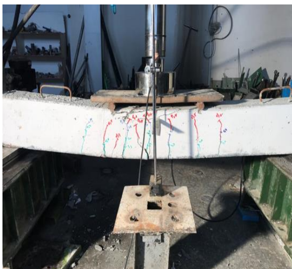
شکل ۸- تیر B0 بعد از اعمال بارگذاری خمشی چهار نقطه‌ای
