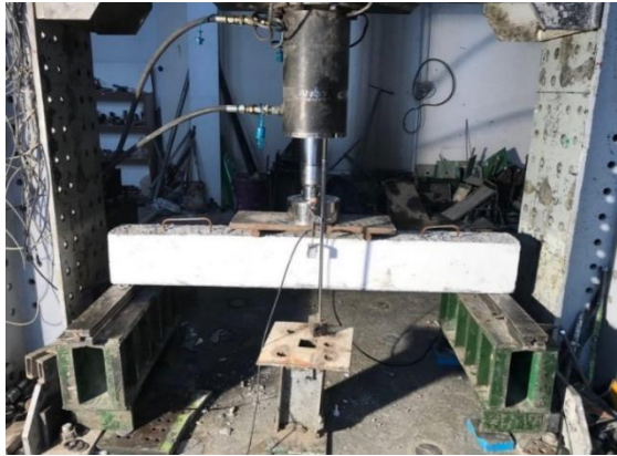
شکل ۷- نمایی از دستگاه بارگذاری خمشی چهار نقطه‌ای
