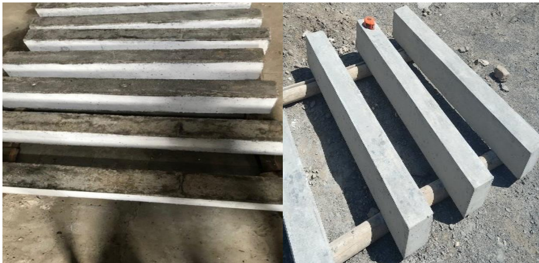
شکل ۲- نمونه تیرهای بتنی ساخته شده
