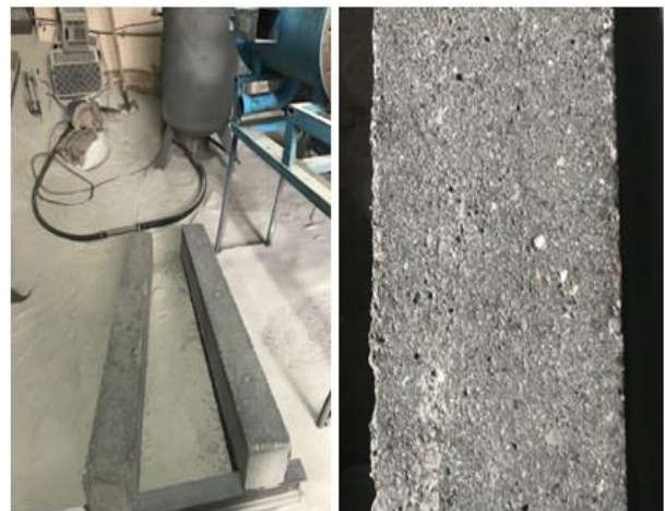
شکل ۵- آماده‌سازی سطح بتن قبل از چسباندن ورق CFRP با روش سند بلاست
