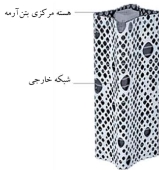
شکل ۳- المان‌های مقاوم سازه‌ای در برج O-14 دبی [30]
