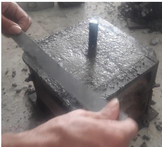
شکل ۴- بتن ریزی، تراکم و تسطیح نمونه‌ها
