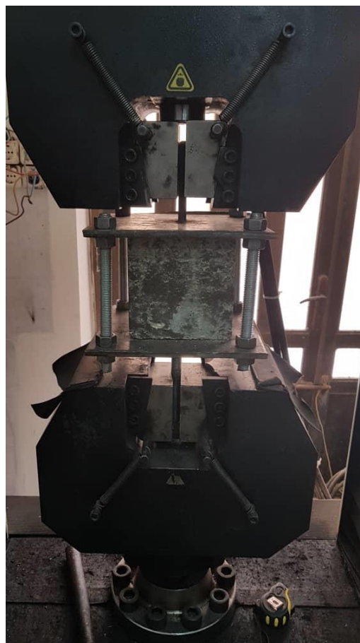
شکل ۵- نحوه انجام آزمایش بیرون کشیدگی
