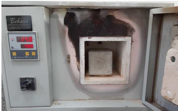
شکل ۳- تصویر کوره الکتریکی و نمودار حرارت-زمان کوره الکتریکی
