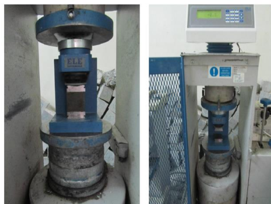
شکل ۶ جک به همراه فک ویژه ی آزمونه مکعبی برای انجام آزمایش مقاومت فشاری
