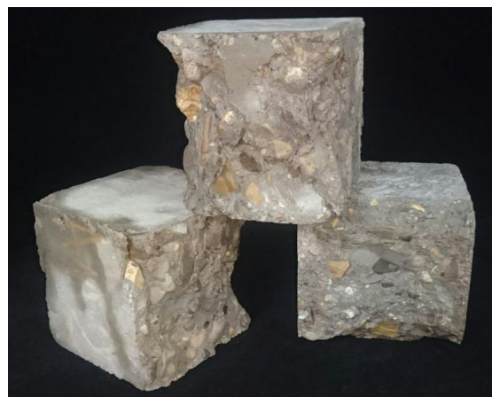
شکل ۷- آزمونه‌های مکعبی بعد از انجام آزمایش مقاومت فشاری
