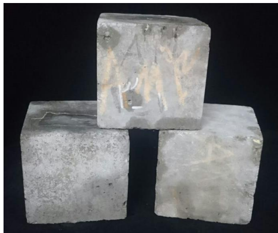
شکل ۵- آزمونه‌های مکعبی آماده شده در آزمایشگاه برای آزمایش مقاومت فشاری
