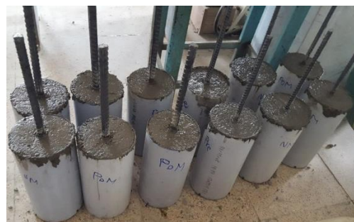
شکل ۴- نمونه‌های بتن جهت آزمایش بیرون کشیدن میلگرد
