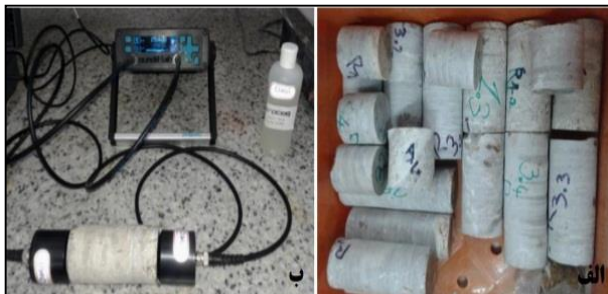
شکل ۸- (الف) مغزه‌های آزمایش سرعت موج P (ب) دستگاه آزمایش به همراه نحوه اتصال مغزه به دیوسرها
