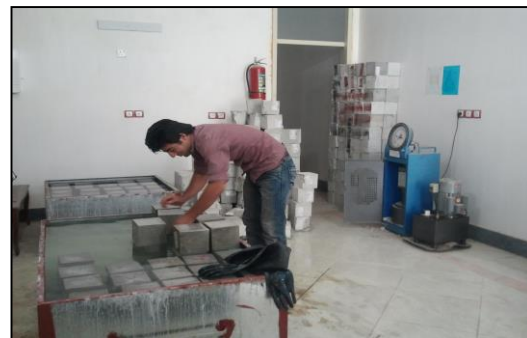
شکل ۹- تصویری از نمونه های بتنی ساخته شده در آزمایشگاه بتن و مراحل عمل آوری آنها
