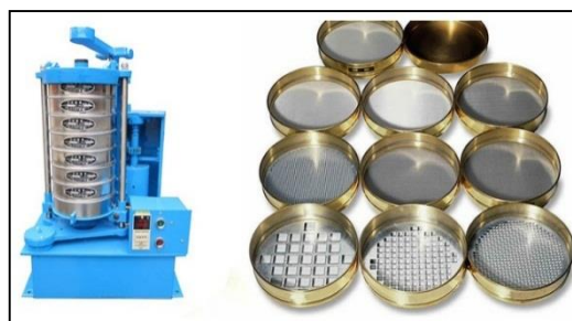
شکل ۶- الک و ویراتور برای آزمایش دانه‌بندی خاک
