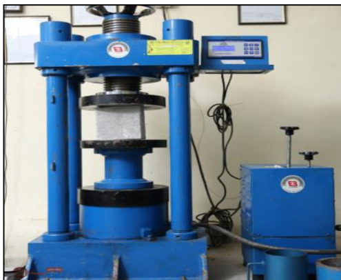
شکل ۱۰- آزمایش مقاومت فشاری نمونه های بتنی
