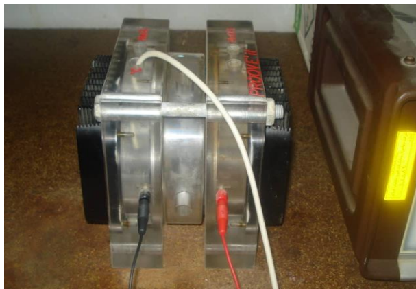
شکل ۱۹- دستگاه آزمایش انتشار پذیری یون کلراید
