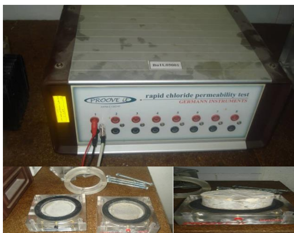
شکل ۲۰- انجام آزمایش انتشار پذیری یون کلراید
