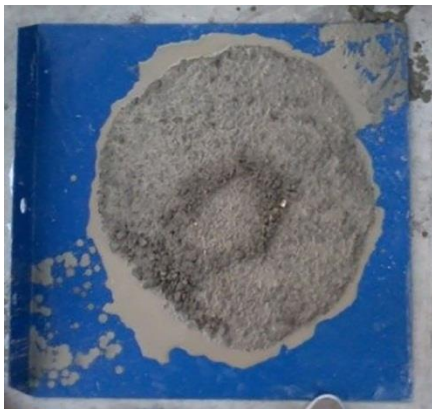
شکل ۴- آب انداختگی بتن
