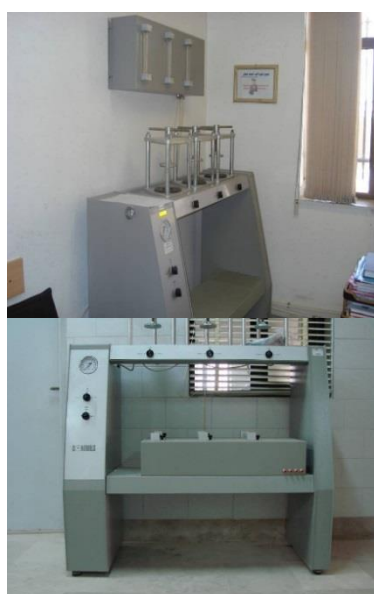
شکل ۱۶- دستگاه آزمایش نفوذ آب تحت فشار
