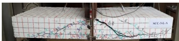
شکل ۱۰- نمونه نواری تقویت شده با الیاف کامپوزیت آرامید (AFRP)
