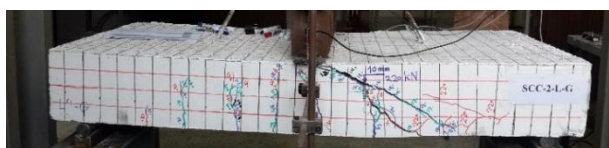
شکل ۹- نمونه نواری تقویت شده با الیاف کامپوزیت شیشه (GFRP)
