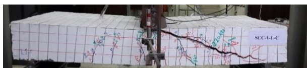
شکل ۸- نمونه نواری تقویت شده با الیاف کامپوزیت کربن (CFRP)
