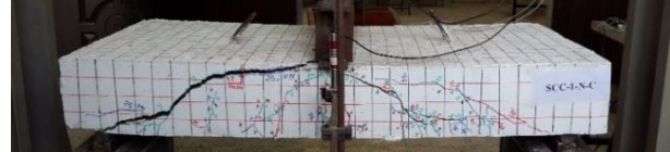
شکل ۱۲- نمونه شبکه ای تقویت شده با الیاف کامپوزیت کربن (CFRP)
