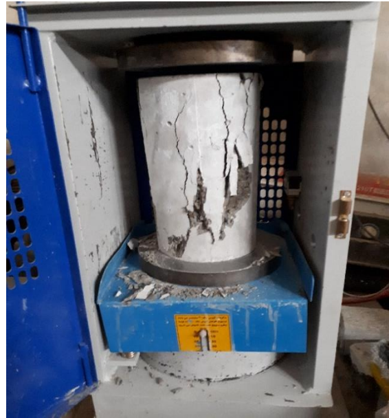
شکل ۱- نمایی از نمونه و آزمایش مقاومت فشاری
