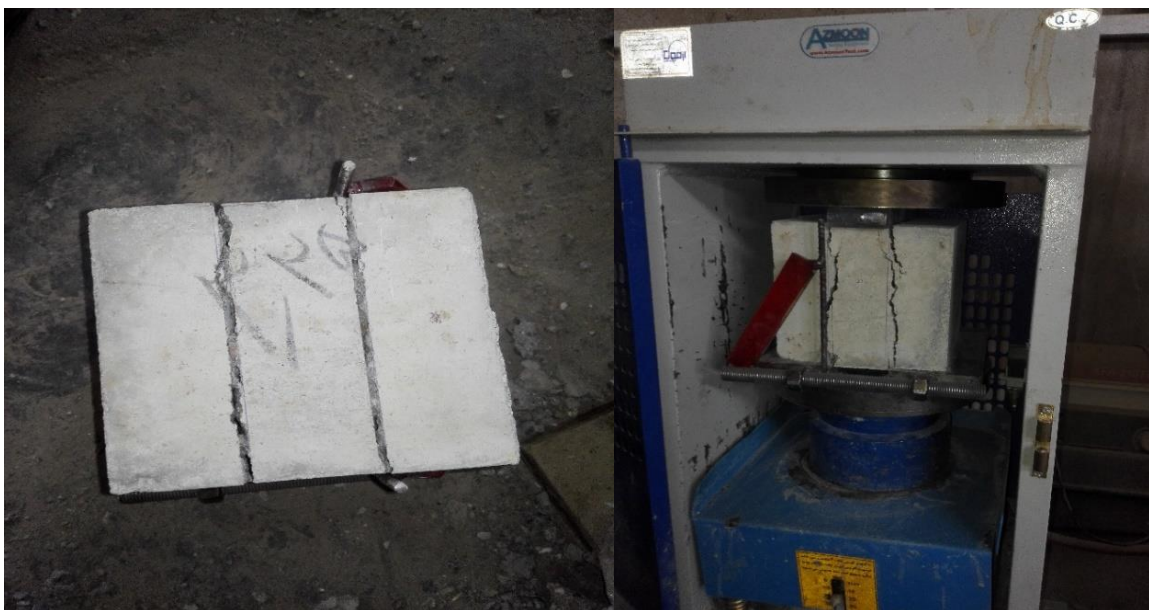
شکل ۲- نمایی از ست‌آپ استفاده شده و نحوه شکست نمونه‌ها در آزمایش مقاومت برشی
